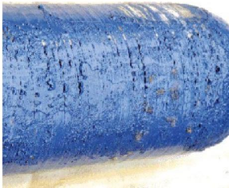
**Abbildung 8: Chemische Beschädigung**
