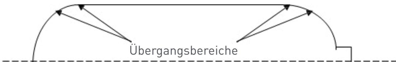
Hinweis: Die maximal zulässige Fehlertiefe ist für den Wand-/Bodenübergang und die Wand-/Schulterübergänge um 1/3 zu reduzieren.
