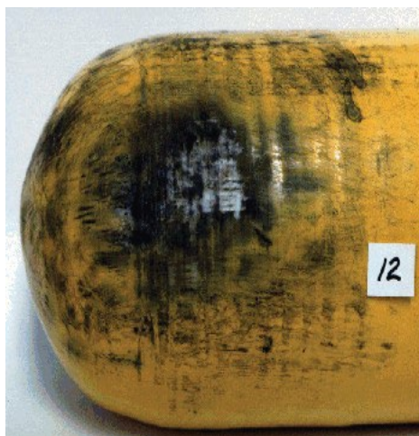
Figur 6: Värme- eller brandskada
